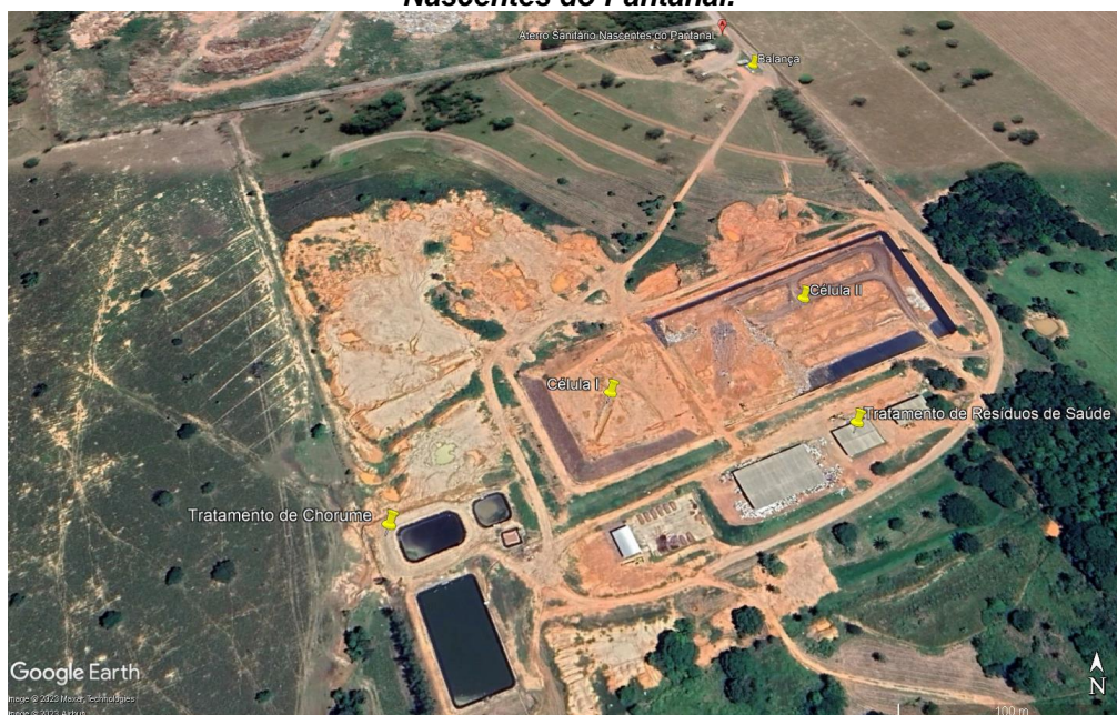
Figura 7 – Mapa de Localização das estruturas do aterro sanitário do Consórcio Complexo das Nascentes do Pantanal.
